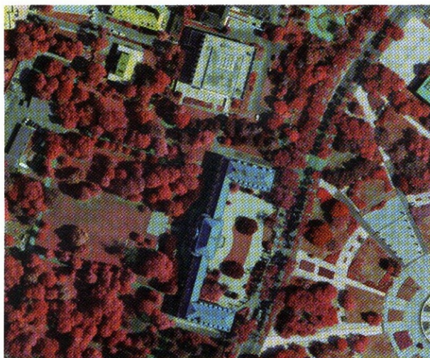
Obr. 8 – Příklad použití barevné infračervené ortofotomapy k inventarizaci městské zeleně Bratislavy (použita digitální kamera Vexcel s rozlišením rozlišení 10 cm/pixel).
