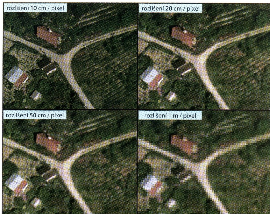
Obr. 7 – Porovnání stejné části krajiny zobrazené na ortofotomapě s různým rozlišením v území
