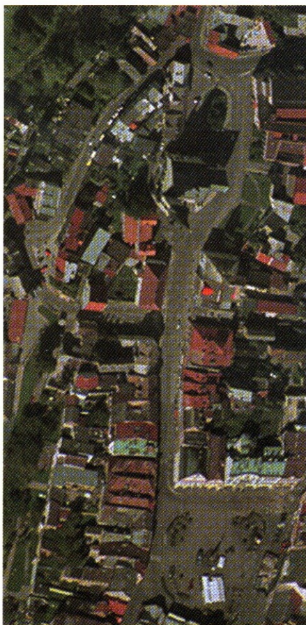
Obr. 1, 2 – Vlevo část ortofotomapy ze dvou leteckých měřičských snímků pořízených širokoúhlovou komorou na film (2000) s výraznými náklony staveb; vpravo stejný výřez z ortogonalizovaných snímků pořízených normální digitální komorou (2007) s vyšší radiometrickou kvalitou
