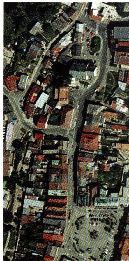
Obr. 1, 2 – Vlevo část ortofotomapy ze dvou leteckých měřičských snímků pořízených širokoúhlovou komorou na film (2000) s výraznými náklony staveb; vpravo stejný výřez z ortogonalizovaných snímků pořízených normální digitální komorou (2007) s vyšší radiometrickou kvalitou
